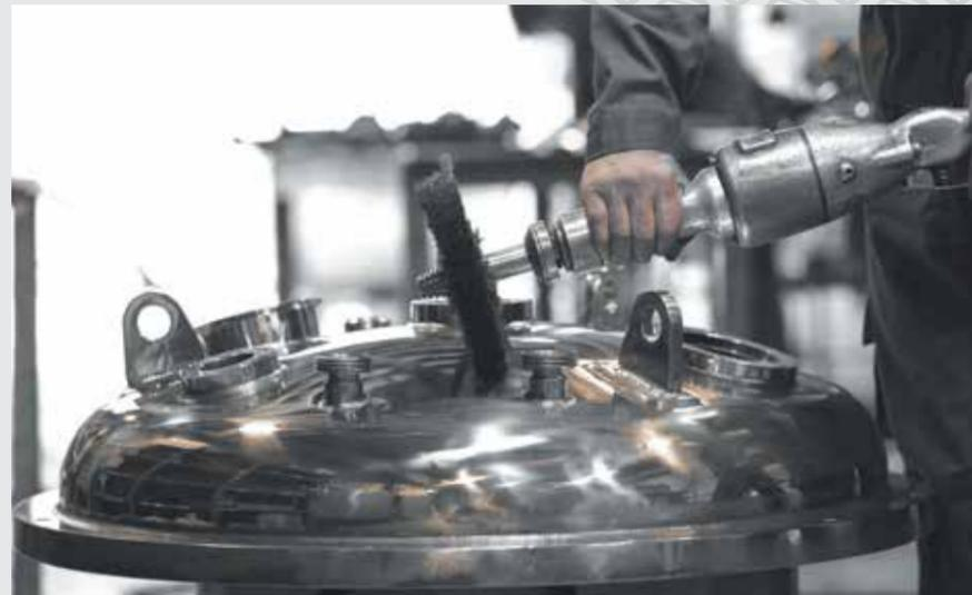
Все детали находятся в контакте с продуктом из нержавеющей стали 316 L с гальваническим покрытием с поверхностным фильтром менее 0,4 мкм:
